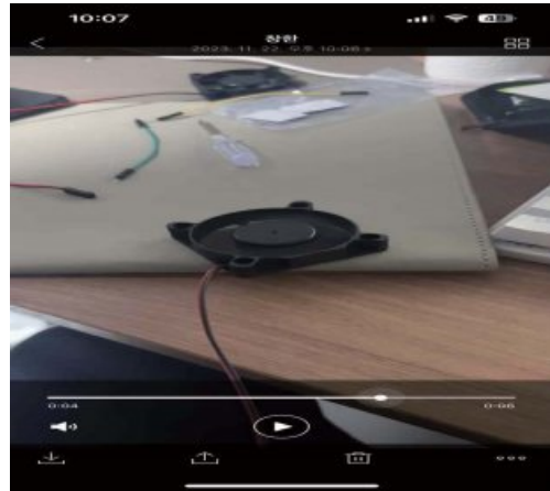
[그림 5] 온·습도를 설정해둔 기준 값 보다 높아 ON이 출력출력되어 팬이 움직일 때
