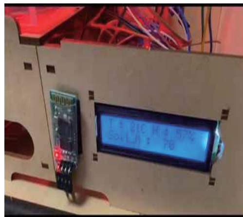
[그림 14] 온습도 센서, 토양수분센서에서 값을 받아온 뒤 LCD화면에 온 습도, 토양수분량을 띄움
