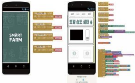
[그림 11] 토양 습도 상태(% , 그림) - 토양 습도 상태를 퍼센트로 나타내며 25, 50, 75를 기준으로 빈 그림이 가득참
