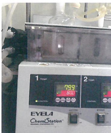
▶ Fig 12. 퍼스널 유기합성장비를 사용하여 반응 중인 모습 반응물, 촉매, 용매를 상온에서 넣어준 후 80℃ 까지 온도를 올리고 21시간 동안 반응시킨다.
